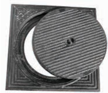
L'emboîtement du cadre et du couvercle est exécuté à double dent et rainure. Il suffit de les enduire de graisse pour assurer une certaine étanchéité. Ces regards s'ajustent parfaitement sur les chambres de visite en PVC. On peut également faire usage d'une margelle en béton préfabriquée qui fait fonction de surface d'appui pour le couvercle.
